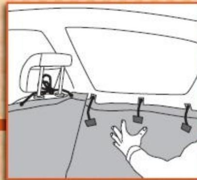
Plane ausrichten (Seitenwände).
