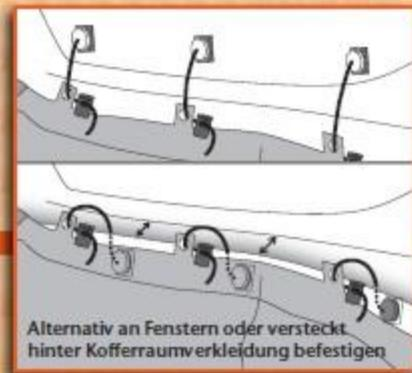
Alternativ an Fenstern oder versteckt hinter Kofferraumverkleidung befestigen
