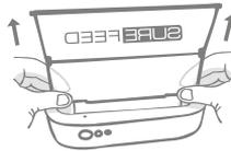
Drehen Sie den Futterautomaten mit der Rückseite zu sich und nehmen Sie die Abdeckung ab.
