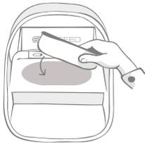
Plaats het gevulde schaaltje terug en druk op de knop openen/sluiten (◊) om het deksel te sluiten en het voer af te sluiten. De voerbak kan nu normaal worden gebruikt.
