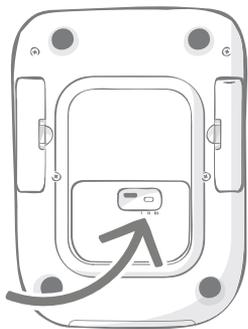
Fördröjningsreglaget finns på undersidan av foderautomaten.
