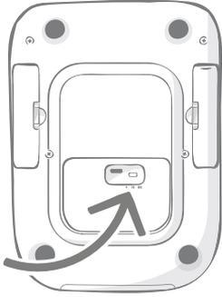
Viiveen liukusäädin löytyy syöttölaitteen pohjalta.
