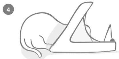
4 Wanneer uw huisdier uit het schaalpje en is geprogrammeerd, stopt het lampje met knipperen en blijft het branden. Wanneer uw huisdier wegloopt, gaat het deksel dicht en gaat het groene lampje uit. Zijn chipnummer is nu permanent opgeslagen in het geheugen, zelfs wanneer de batterijen worden verwijderd.
