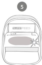
Innan du sätter tillbaka skålen i foderautomaten, se till att alla foderautomatens ytor är rena och att det inte finns något spill kvar under skålen. Detta gör att locket kan röra sig fritt och försluta skålen helt.
