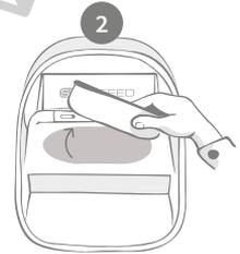
Entfernen Sie die schmutzige Schale für die Reinigung.
