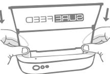
Nach der Reinigung setzen Sie die Abdeckung in flachem Zustand wieder ein und falten sie dann zusammen.
