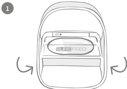
1 Entfernen Sie zuerst die Matte und stellen Sie dann den Futterautomaten auf den Kopf, um an das Batteriefach zu gelangen.
